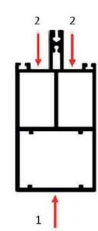
8. Die beiden äußeren Tragprofile einsetzen und verschrauben
